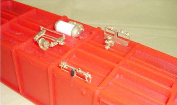
Die Handwinden werden an die Wandunterseite geklebt. Weitere Messing Kleinkram wie Seilhaken, Bremsschlauche, Rangiergriffe, und Handgriffe werden weiter auf den Wagenboden geklebt.
